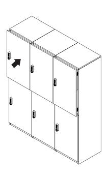
6. ADJUST THE DOOR POSITION TO ALIGN THE DOORS BY USING THE ADJUSTMENT SCREWS ON THE HINGES: 1) UP AND DOWN, 2) LEFT AND RIGHT, 3) INWARD AND OUTWARD
