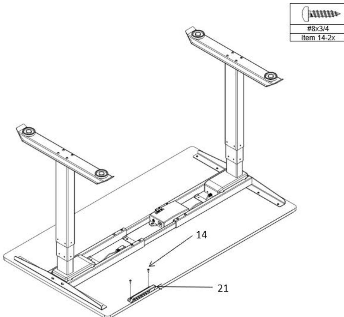
13. Brancher les 2 fils de jonction (item# 19) dans les prises de la boîte de contrôle (item # 20) et dans les fiches des pattes élévatrices (item # 2).
